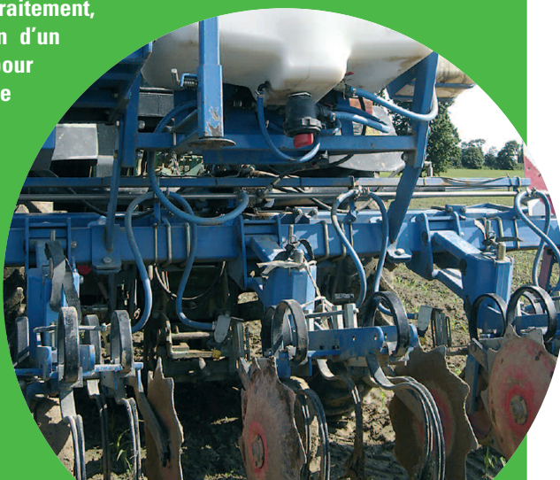
Démonstration de désherbage du maïs (binage dans l'inter-rang et désherbage chimique sur le rang)
